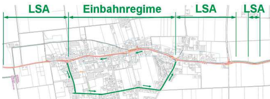
Übersicht über die einzelnen Bauetappen und das Einbahnregime während der zweiten Etappe.
