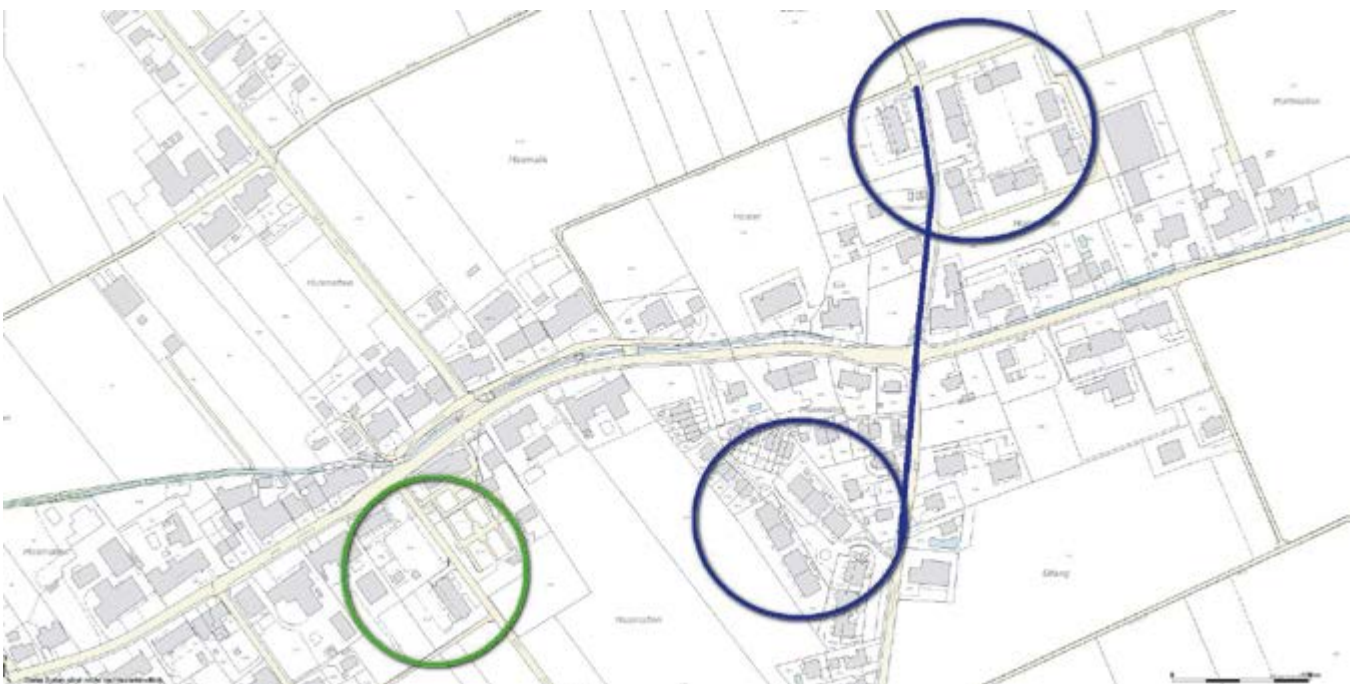
Geplante Fokus-Zonen der beiden Wärmeverbunde «Chilchweg» (grün) sowie «Werdstrasse» (blau). Die Zonen zeigen die etwaigen Erschliessungsgebiete. Die genauen Zonengrenzen sind noch nicht definiert.
